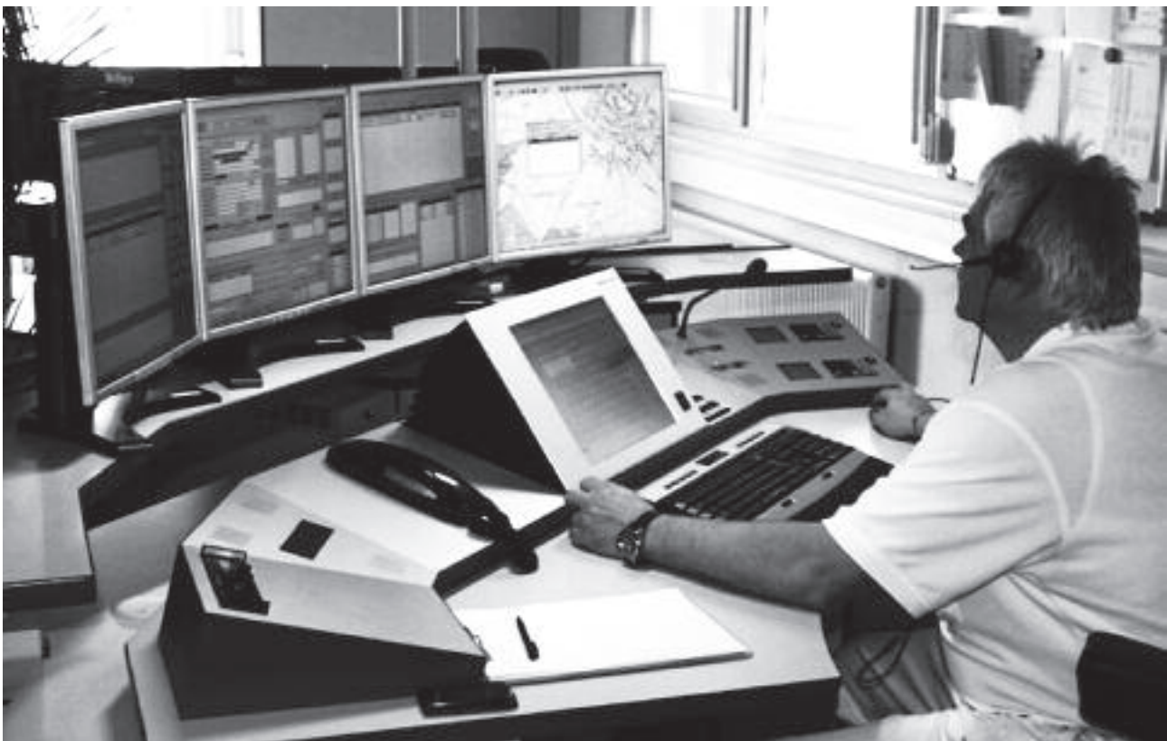
Der Disponent sieht auf den Bildschirmen der Leitstelle die aktuellen Standorte der Einsatzfahrzeuge.
